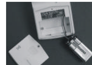
Insérez une batterie alcaline 9V dans le détecteur de mouvements
