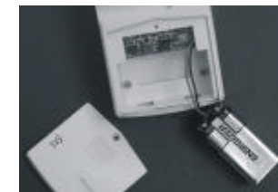
Inserte una batería de alcalina de 9V en el sensor de movimiento
